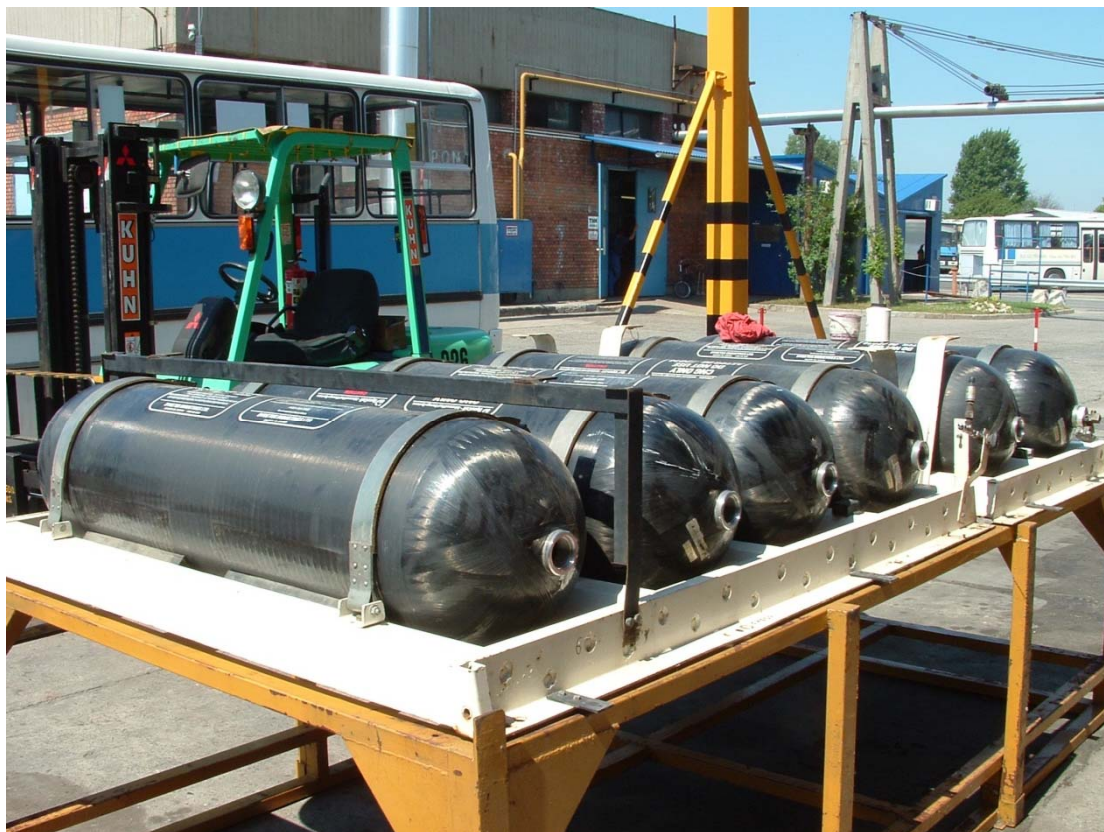
Autóbusz tetőre szerelhető gáztartálya
