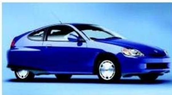
Az emissziócsökkentő fejlesztések másik eredményes iránya a belső égésű és villamos motoros, úgynevezett hibridhajtás. Ilyen erőforrás működik a képen látható Honda Insightban is, amely immár egy éve vezet az amerikai tüzelőanyag-fogyasztási listán.
